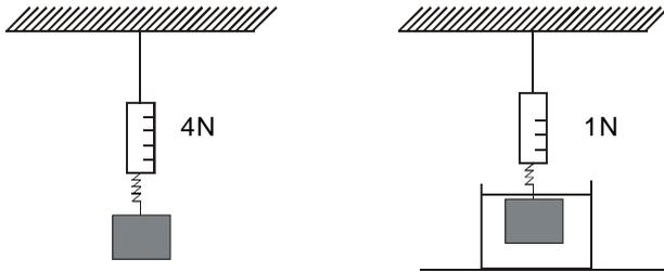
O mesmo bloco é suspenso por um dinamômetro, no ar e, em seguida, é totalmente mergulhado em um líquido. Pode-se afirmar que o empuxo sobre o corpo, em N, vale
